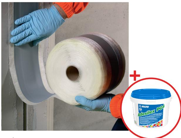
Mapeband TPE est composé d'une bande en TPE de 17 ou 32.5 cm de large et d'une épaisseur de 1.2 mm, renforcé aux bords extérieurs avec un tissu polyester non tissé.
