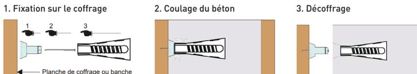
Clouer le cône sur la surface coffrante avec un clou ou une vis de 70 mm, puis insérer la cheville à fond sur le cône.
